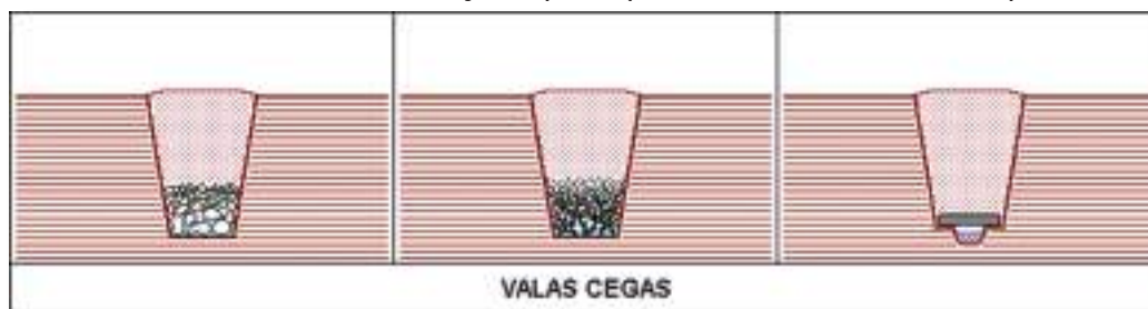
Figura 33 - Sistema de drenagem subterrânea por valas cegas
