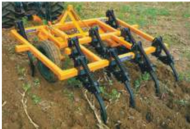
Figura 5 - Preparação mínima com escarificador pesado.
