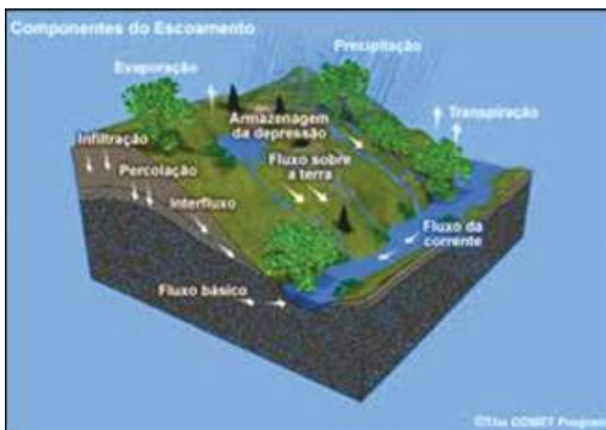
Figura 26 - Escoamento de águas superficiais
